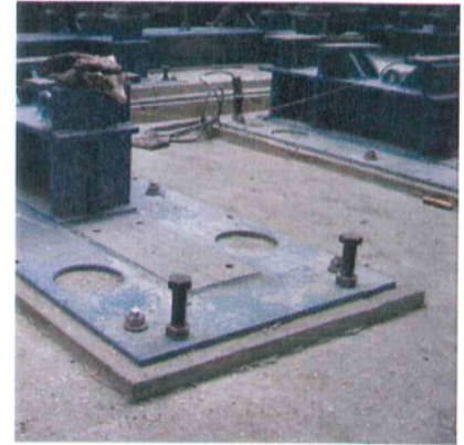
Met PCI Repaflow ontstaat een naadloze, scheurloze en holtevrije verbinding, die een rustig machineverloop en nauwkeurig werken mogelijk maakt en de slijtage van machines vermindert.
