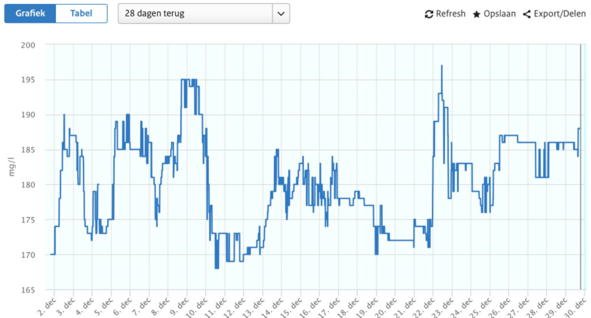
Figuur 1 chlorideconcentratie ter plaatse van innamepunt drinkwater Andijk tijdens droge periode
