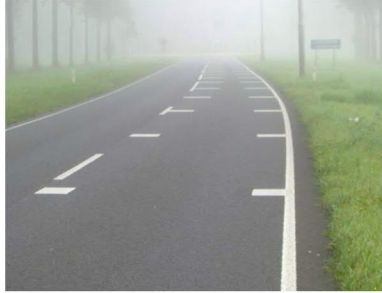
Afbeelding 5.6.3: visuele versmalling (bijvoorbeeld toe te passen op de afrit voorbij het puntstuk).
