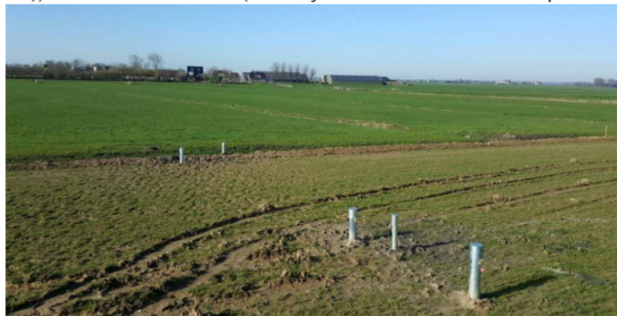
Foto 3. Een voorbeeld van een van de transecten met peilbuizen en ceramische cups langs de dijk.
