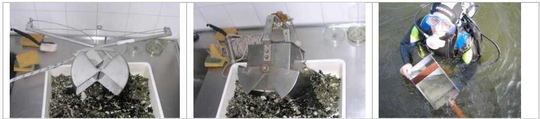
Figuur 3-5 Drie sediment monster methoden onderzocht door Lengkeek et al (2008, 2010), links Van Veen happer, midden Birge-Ekman happer, rechts duiker met bodemschep
