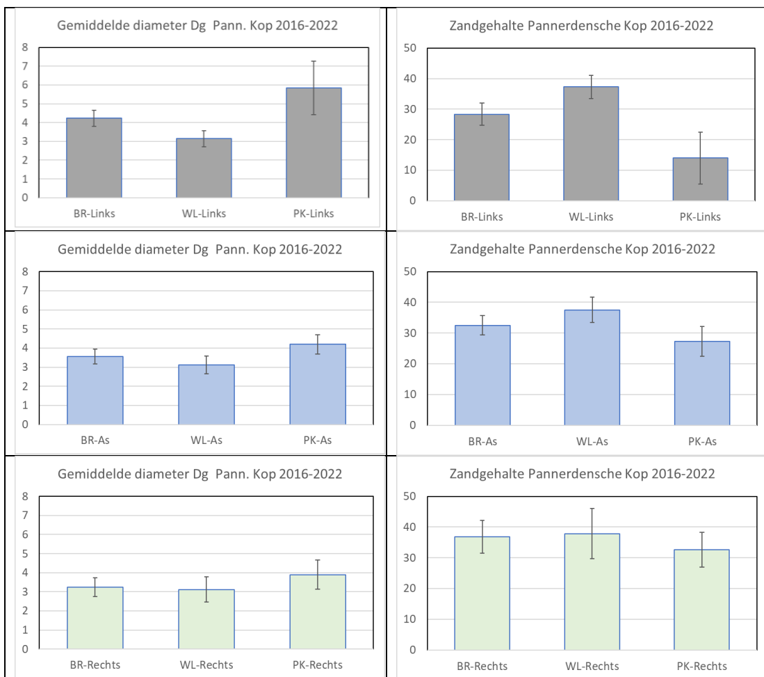
Figuur 2-19 Berekende tijdgemiddelde diameter D_g en zandfractie (data suppletieproeven 2016-2020 en campagne 2020) voor de riviertrajecten met lengte circa 2 km rond de Pannerdensche Kop. Onderscheid is gemaakt in linkerzijde, rivieras, en rechterzijde van de rivier. Ook is de standaardafwijking van de waarden weergegeven (aangegeven als 'error bars').
