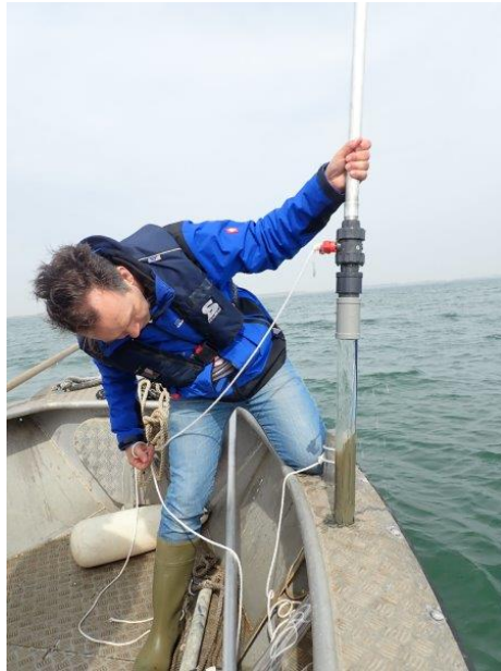
Figuur 8-16: Bemonstering met de steekbuis. Te zien is het onderste deel van de 6-meter aluminium buis met daaronder de kraan en de doorzichtige steekbuis met het genomen monster.
