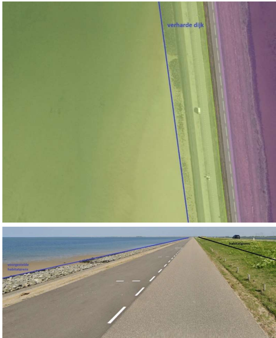
Figuur 2a en b Voorbeeld van de Oosterdam, met het habitatgebied in geel (bovenste foto a), waar een brede strook (basalt, ingelegde stenen, stenen en een grazige berm, zie onderste foto b) tot aan de zwarte grens tot het habitatgebied behoort. De blauwe lijn is een voorstel voor verbetering.
