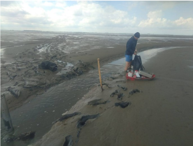
Figuur 2.2b Foto monstername met de Steekbuis in de Waddenzee
