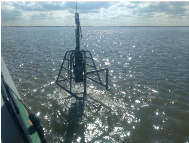
Figuur 2.2a Foto monsternamen boxcorer op de Waddenzee
