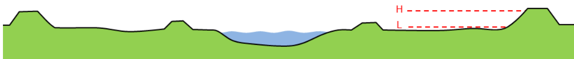
Figuur i-1: Schematische doorsnede van een Nederlandse rivier met winter- en zomerdijken, uiterwaarden en een stroomgeul. De lijn L markeert de ondergrens en de lijn H markeert de bovengrens.
