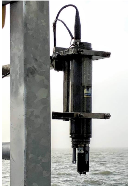
Figuur 87 Multi Parameter Probe bij FL67. -- YSI, type: 6600v2-4
