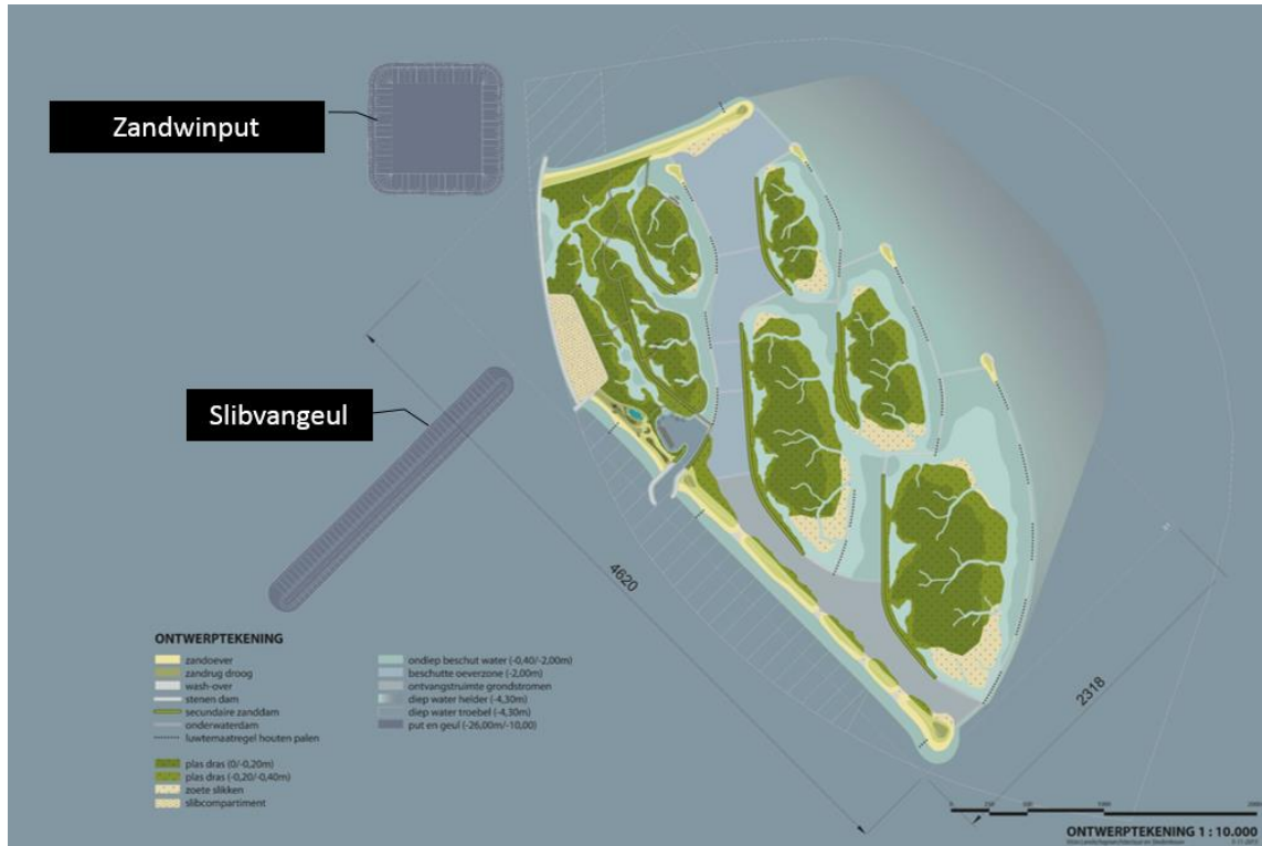
Afbeelding 4.1 Ontwerp van de Marker Wadden en ligging van de zandwinput en slibvanggeul
