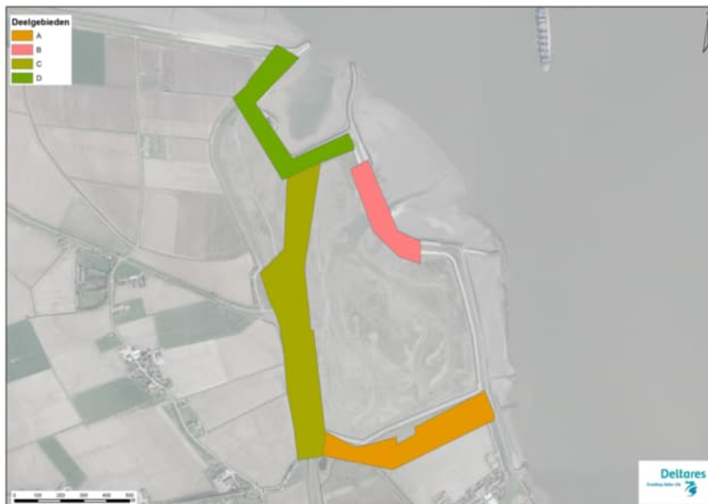
Figuur 2: Dijkvakken waarin TGG is toegepast, liggen in de Deelgebieden A, C en D. Deelgebied B betreft de voormalige zeedijk die bij de ontpoldering is verwijderd.
