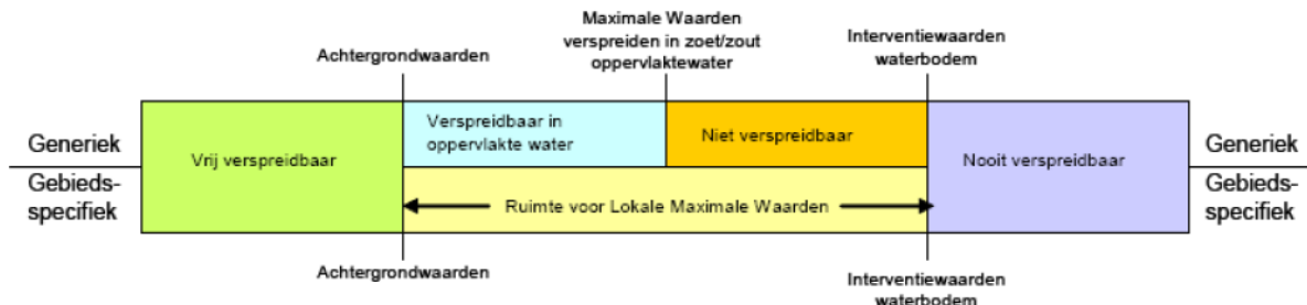
FIGUUR 2: NORMSTELLING VOOR VERSPREIDEN VAN BAGGERSPECIE IN OPPERVLAKTewater IN HET GENERIEKE- EN GEBIEDSSPECIEFIE KADER
