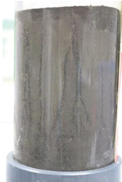
Foto 4.2 Opstelling doorlatendheidsproef. Gedurende de test wordt een kanaal zichtbaar bestaande uit louter grof materiaal
