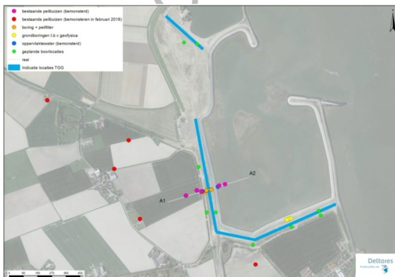
Figuur 3.8: Indicatieve ligging van zeedijk waar de TGG is toegepast en de verschillende locaties van de monsternames. De oranje en gele bollen
