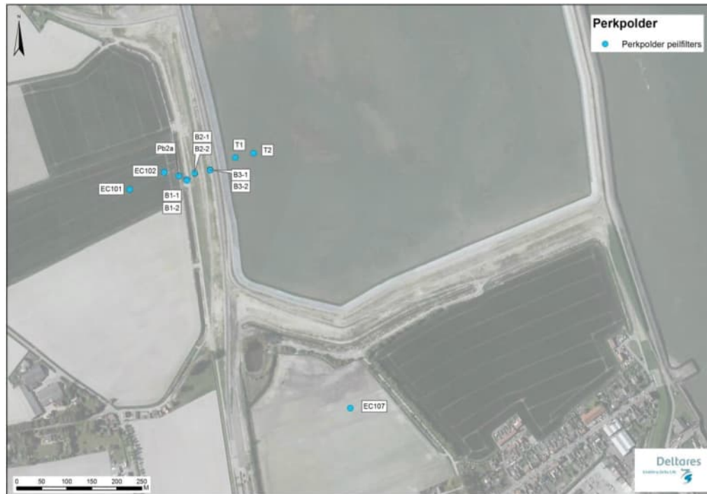
Figuur 2.1 Locaties van peilbuizen (alle punten) en kernboringen (aangeduid met B)
