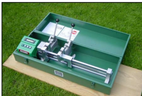
Controle lasverbindingen op de bouwplaats met mobiele trekbank
