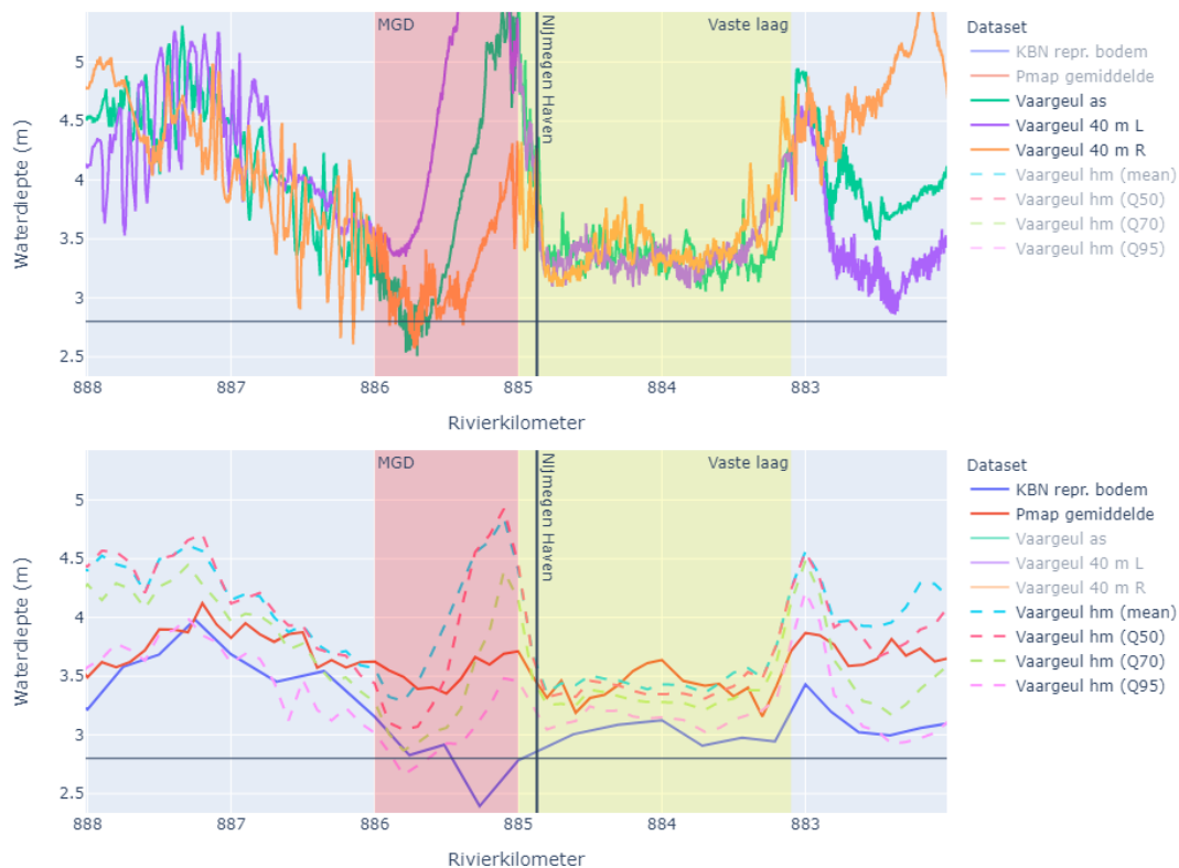
Figuur 2.6 Waterdiepte ter hoogte van Nijmegen bij een afvoer bij Lobith van 1.020 \text{ m}^3/\text{s} . Om de informatie leesbaar te houden is de figuur opgesplitst. In de bovenste figuur staat de waterdiepte op drie locaties in de vaargeul: midden van de vaargeul, 40 m links uit het midden, 40 m rechts uit het midden. In de onderste figuur is informatie samengevat per hectometervak volgens verschillende methodieken: de representatieve bodemhoogte van KBN (blauw), en de gemiddelde waterdiepte volgens de P-mapmethodiek (rood). Daarnaast zijn voor ieder hectometervak het gemiddelde en de percentielen 50%, 70% en 95% berekend.
