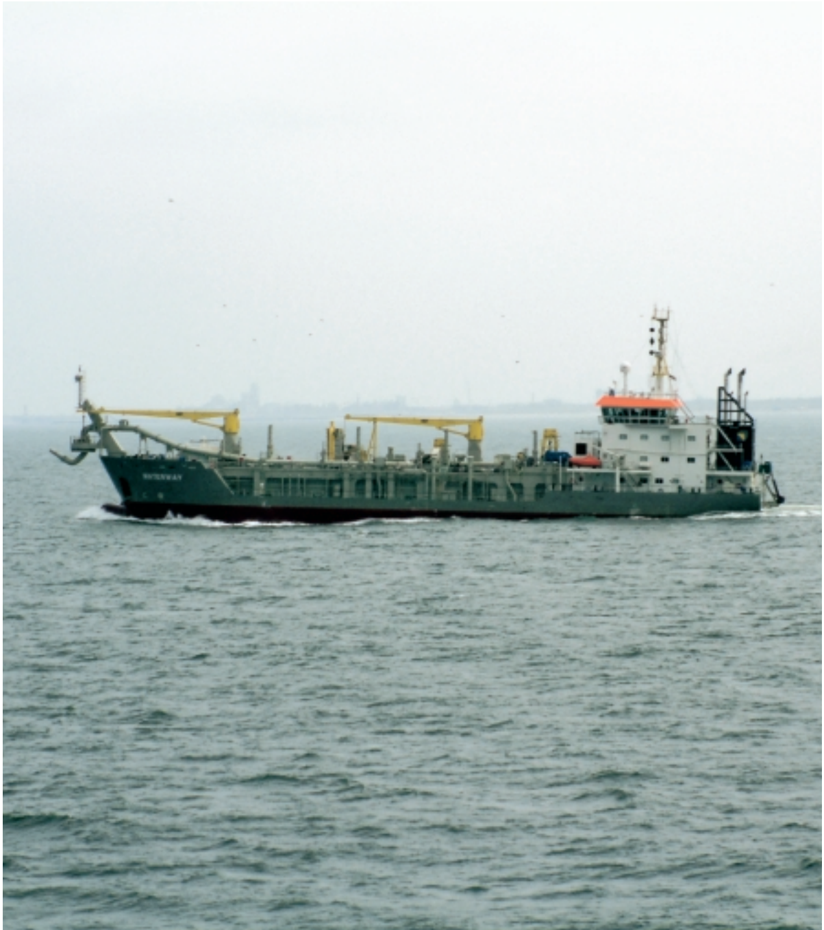
Voor onderwatersuppleties zijn schepen met een beperkte diepgang nodig. Hier de sleehopperzuiger "Waterway". (Foto Directie Noordzee RWS)
