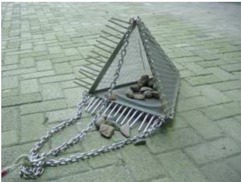
Foto 8.1 De werpkorf is gebruikt voor de biotoopbemonstering op de Grensmaas The triangular dredge has been used for biotope sampling in the Common Meuse
