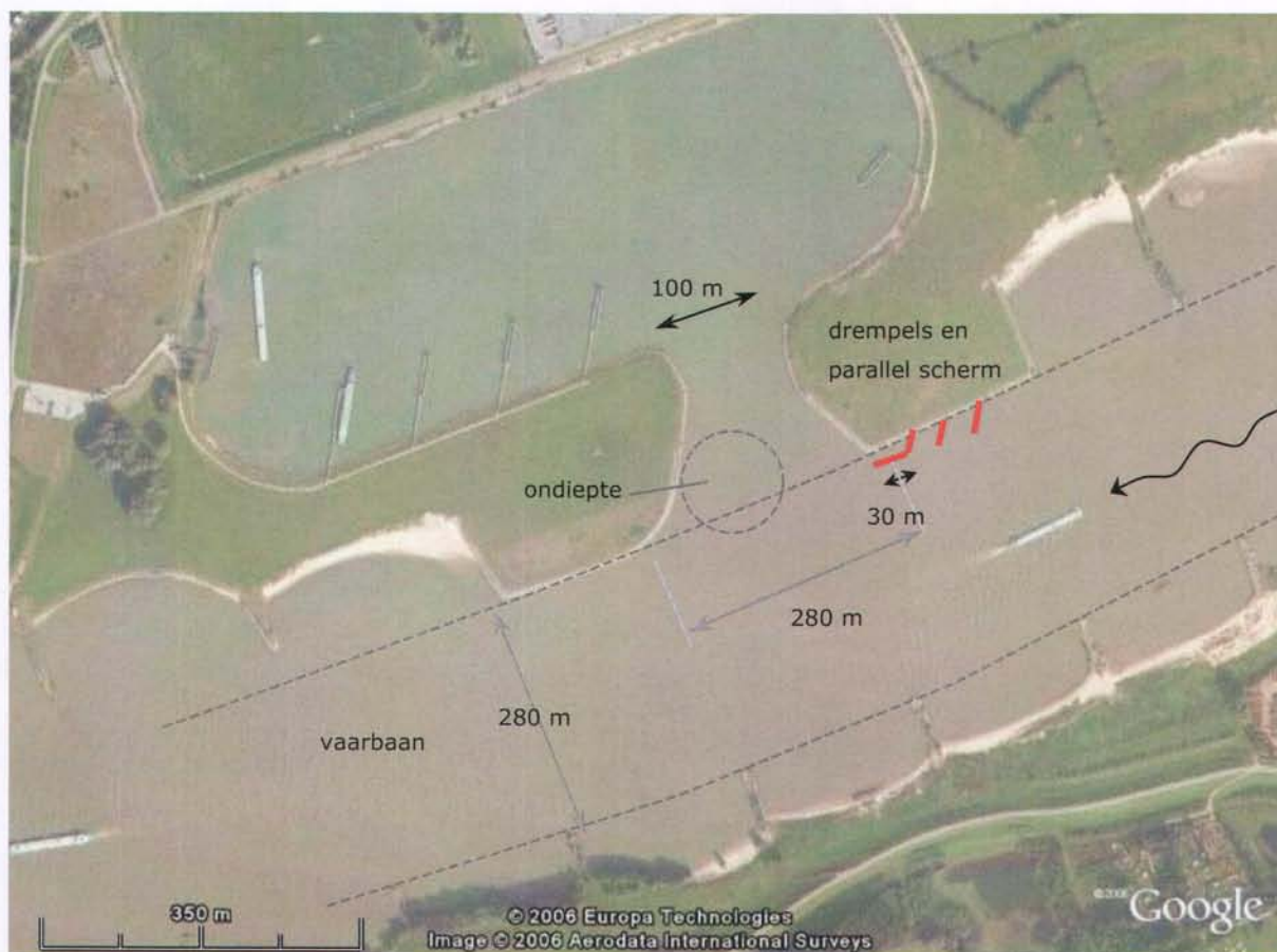
Figuur 4-11 Principe haveningang met drempels en parallel scherm overnachtingshaven Haaften
