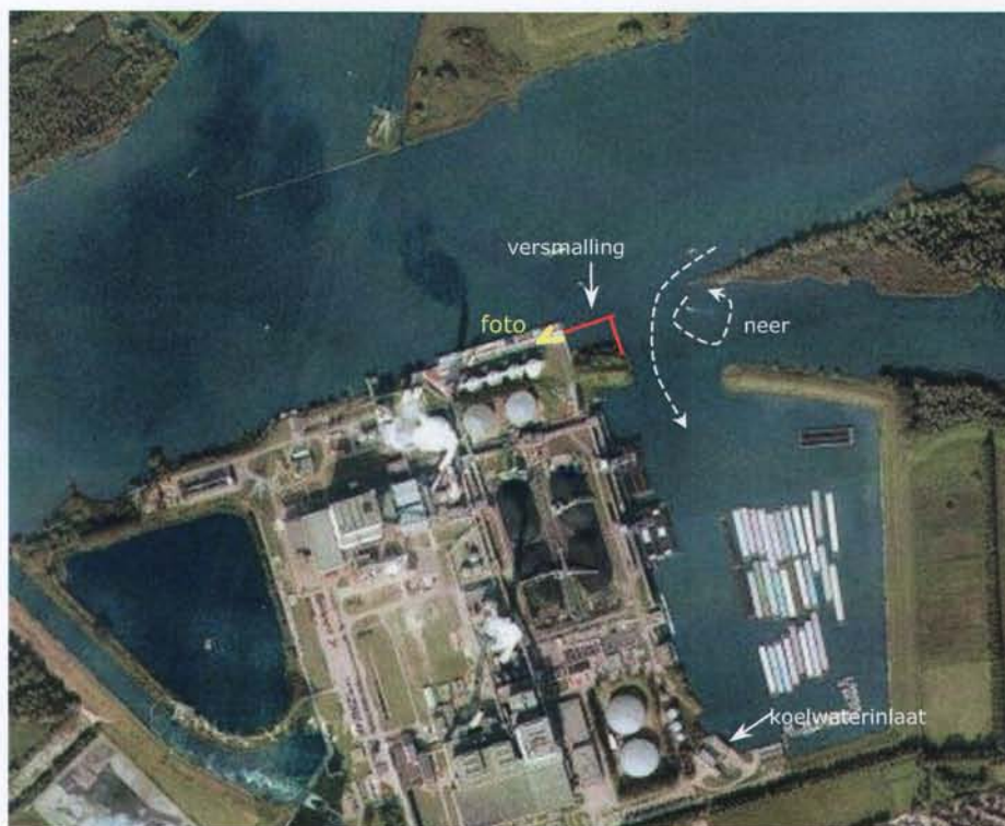
Figuur 4-1 Principe van versmallen haveningang industriehaven Amercentrale
