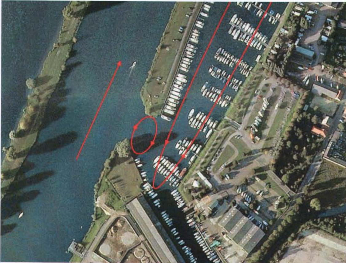
Figuur D-2 Geschematiseerde circulatiecellen in de haven van Roermond (op basis van Van Schijndel en Kranenburg, 1997)
