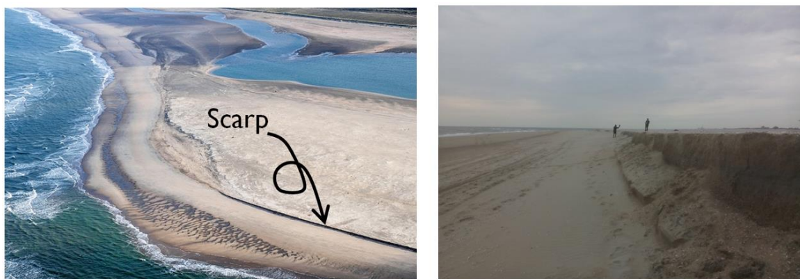
Figuur 4.3 Steilrand op de zeewaartse zijde van de Zandmotor (De Schipper et al., 2017; Luchtfoto : Rijkswaterstaat - Joop van Houdt)
