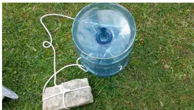
Foto 2.8 Bovenaanzicht larvenfuik met verzwaring, de inzwemopening is te zien.
