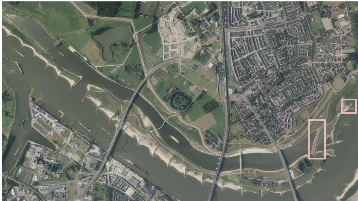
Figuur 2.1. De Spiegelwaal en Lentse Waard (bron: ESRI Nederland, beeldmateriaal.nl). Het linker kader betreft de dam waarin de inlaatduikers naar de Spiegelwaal zich bevinden. Het rechter kader is de inlaat van de Lentse Waard.
