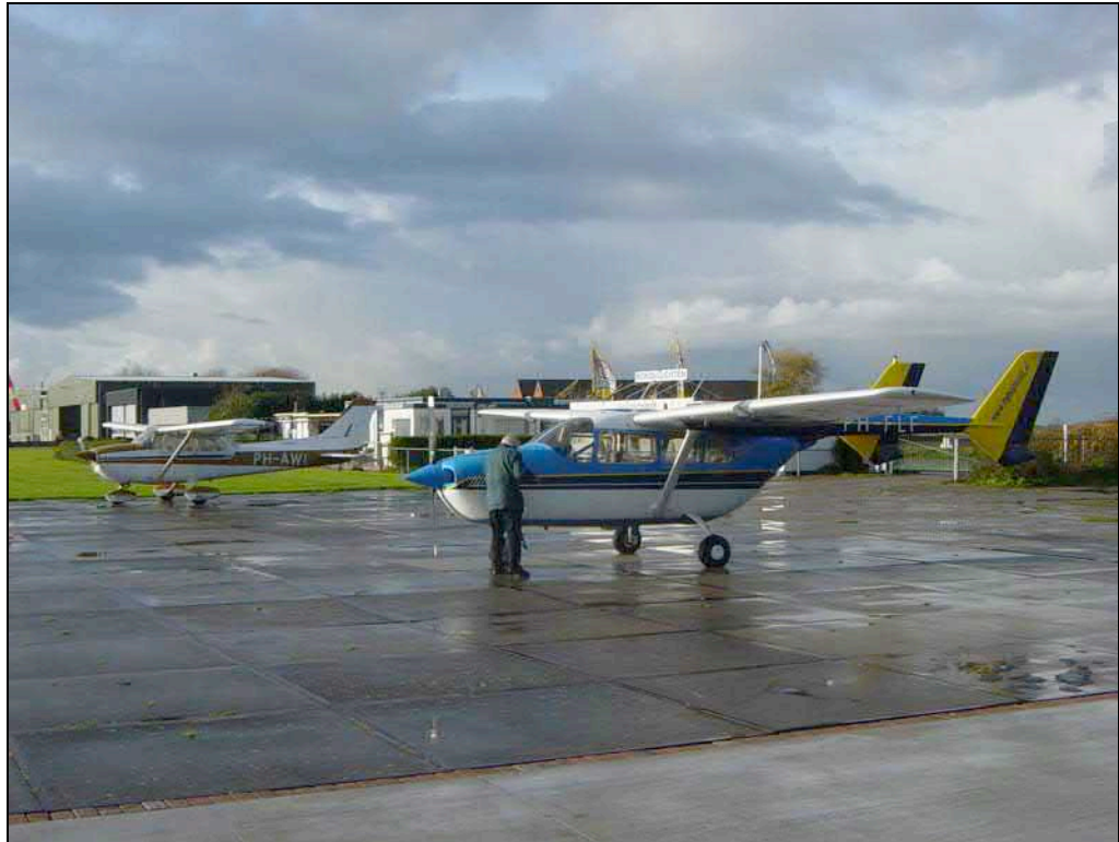
Figuur 2.9. De Cessna337 waarmee de speciale duikertelling is uitgevoerd. Het toestel heeft naast een motor voor een tweede achter, omgeven door de dubbele staart. Het vliegtuig is daarmee veilig om laag (hoger risico van vogelaanvaringen) en langzaam offshore te vliegen. Op de achtergrond het vliegtuig waarmee de zee-eendentellingen als mede de meeuwen en sternstellingen in de zomerperiode werd uitgevoerd.
