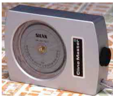
Figuur 2.7. Clinometer waarmee hoeken ten opzichte van de horizon bepaald kunnen worden. De ronde schijf drijft in een vloeibaar bad en blijft net als bij een waterpas onder invloed van de zwaartekracht op dezelfde horizontale positie. Wanneer een object wordt waargenomen kan met één oog gericht op de vogel beneden op zee en het andere oog door het kijkgat de hoek afgelezen worden waaronder gekeken wordt.
