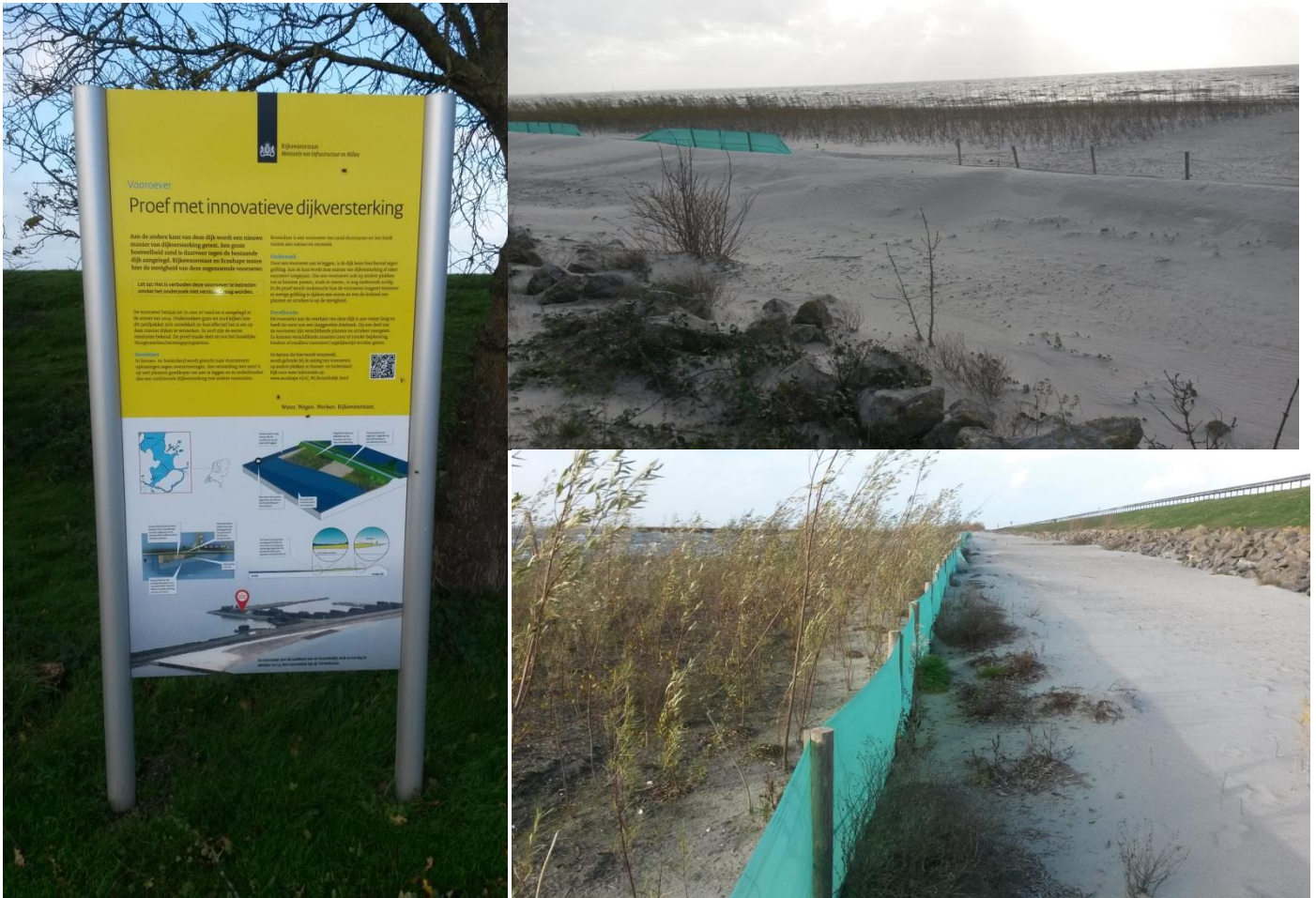
Figuur 2.4 Foto impressie (d.d. november 2015) – het informatiebord, kapotte stuifscherm en vegetatie in de luwte van het stuifscherm achter de vegetatie.
