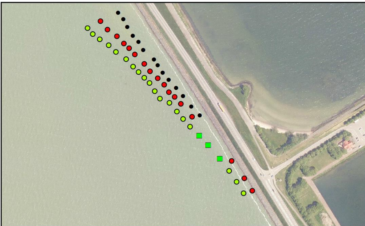
Figuur 4.7 Ligging monsterpunten grid. Raai 1 = groen, raai 2 = rood, raai 3 = zwart. Raai 1 is genummerd van NW-ZO 1 t/m 22 (rijsmat is nummers 17, 18 en 19, groene diamanten), raai 2 is genummerd van ZO-NW 23 t/m 39, raai 3 is genummerd van NW-ZO 40 t/m 53.
