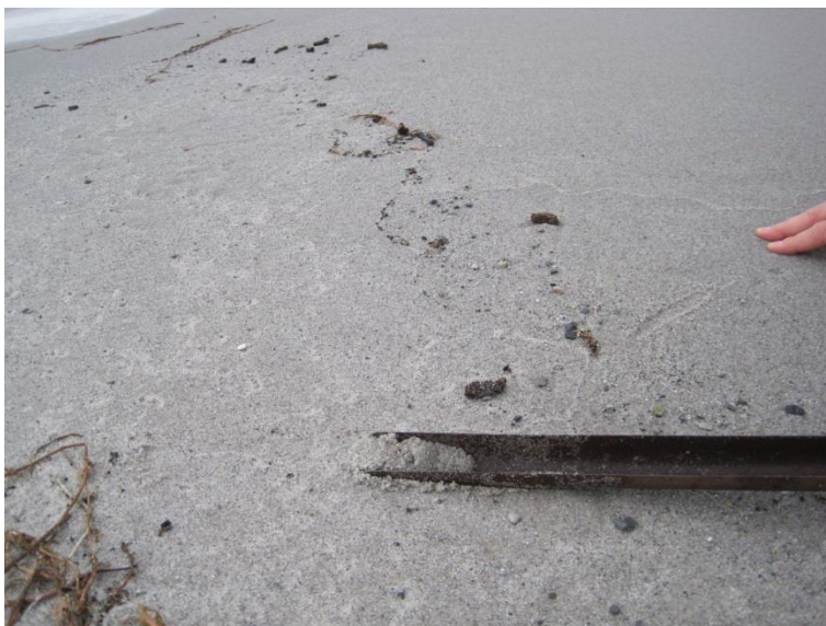
Figuur 4.8 Horizontale monstername met grondboor zodat alleen de bovenste 0,5 cm bemonsterd wordt.
