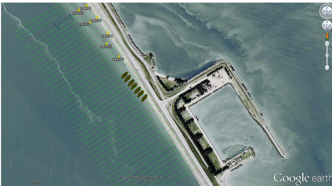
Figuur 4.1 Meetgebied met daarin aangegeven: meetraaien (groene lijnen), zakkbakens (gele markers), meetraaien over wiepen in rijsmattenvak (donkergroene markers)
