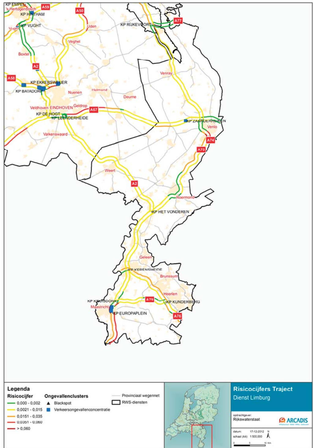
Figuur 3.69 Risicocijfers per traject, black spots en verkeersongevallenconcentraties RD Limburg [Bron: MinIenM, 2011a]
