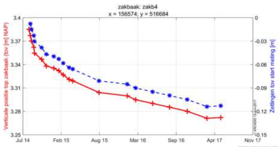
Figuur 6-44 Absolute ontwikkeling top van het zakbaken voor zakb4 (rode lijn), samen met de bijbehorende zetting (blauwe lijn).
