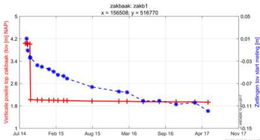
Figuur 6-41 Absolute ontwikkeling top van het zakbaken voor zakb1 (rode lijn), samen met de bijbehorende zetting (blauwe lijn).
