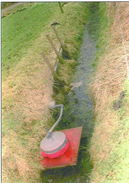
AFBEELDING 5.3 MEETGOOT VOOR ANALYSE VAN DE RUN-OFF
