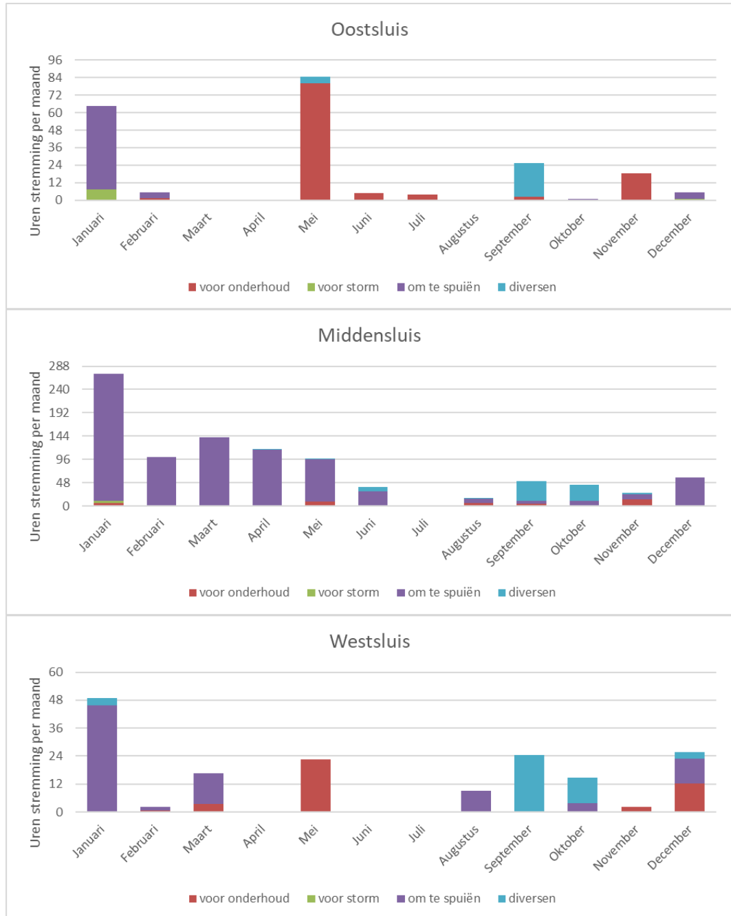
Figuur 5.2 Geregistreerde stremmingen in 2018 bij de Oost-, Midden- en Westsluis. De 'diversen' beslaan in september en oktober met name stremmingen met als tekstuele opmerking: 't.g.v. laag kanaalpeil' en 'lager dan minimum'. De middenkolk is in september en oktober gestremd geweest in verband met werkzaamheden.
