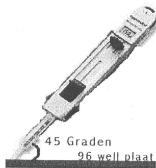
Figuur 8.2 Positionering van een repetierpipet tijdens het uitvullen van microtiterplaten.
