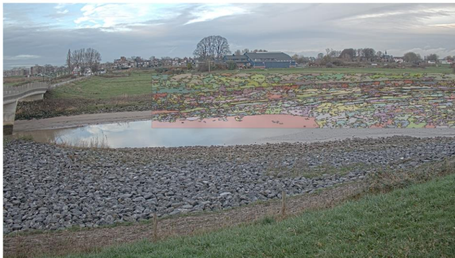
Figuur 21 Gedeeltelijke segmentatie ter plaatse van de oeverlijn. De segmenten zijn hier met willekeurige kleuren aangegeven.
