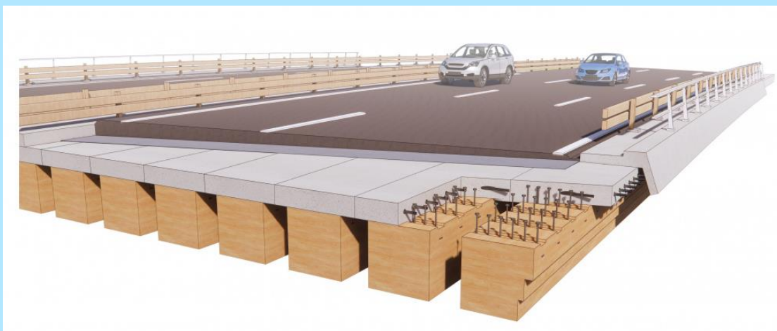
Figuur 2 Een innovatief viaduct met een hout-betonligger (bron: Mobilis)
