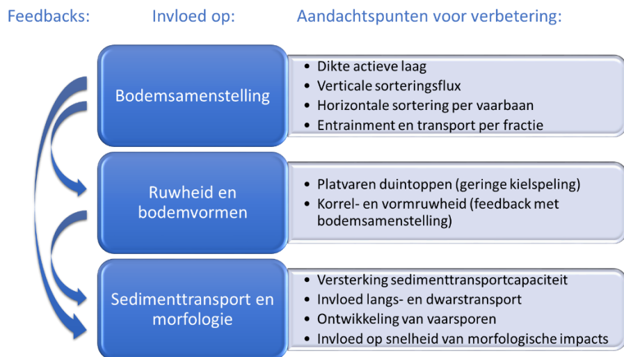
Figuur 4-1 Diagram voor modellering van processen (en hun feedbacks) voor invloed van scheepvaart op de morfologische processen
