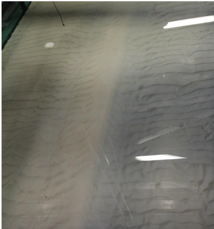
Figuur 2-3 Vaarspoor in laboratorium goot gecreëerd door een getrokken schip over een zandbodem met ribbels (Robijns, 2014)
