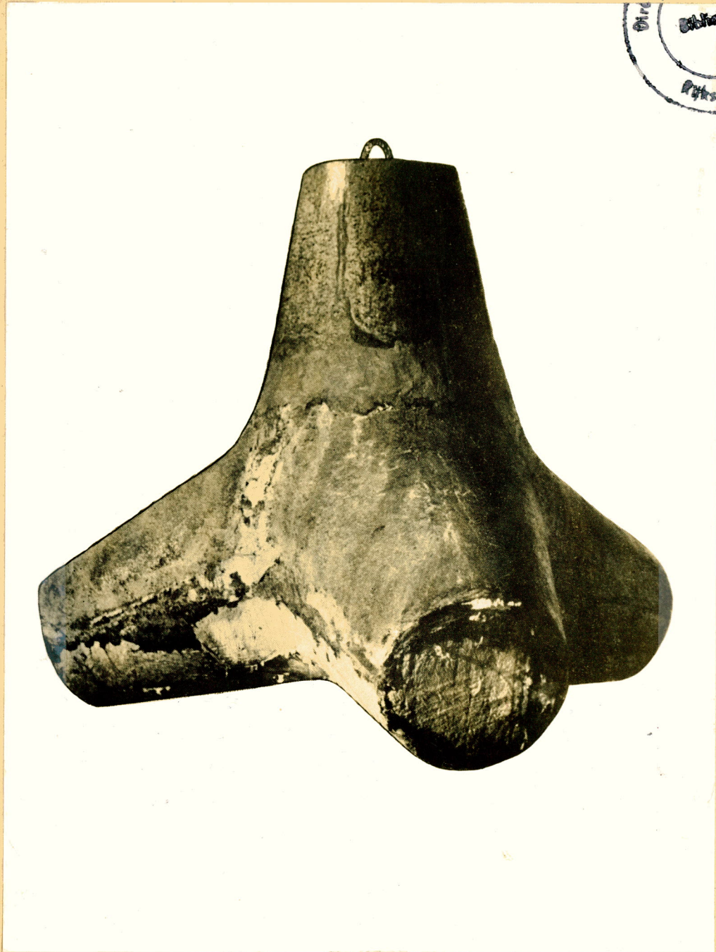
Fig. 1. De tetrapod, ontwikkeld door het Laboratoire Dauphinois d'Hydraulique (NEYRPIC) te Grenoble, ten behoeve van het bestorten van golfbrekers of havendammen.
