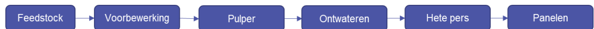
Figuur 4.7 Schematische weergave van ECOR proces. In de voorbereiding wordt input materiaal geshredderd en bij agro-stromen worden de eiwitten verwijderd. Vervolgens wordt de feedstock met water gemengd in de pulper. In de volgende stap wordt er ontwaterd en in een hete pers worden de panelen afgebakken
