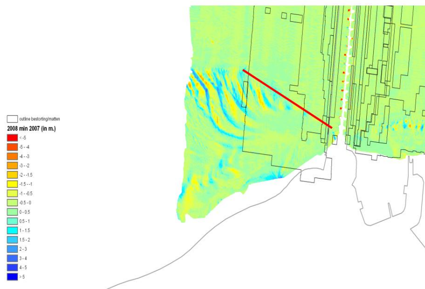
Figuur 4.5: lopende zandgolven op het zuidelijke deel van de blokkenmatten in de Roompot zeezijde.
