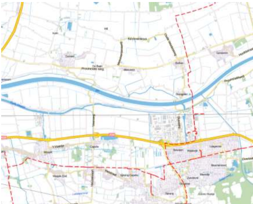
Figuur 10 Gasleiding in Gemeente Waalwijk. Deze kruist de Bergsche Maas in het beschermingsgebied
