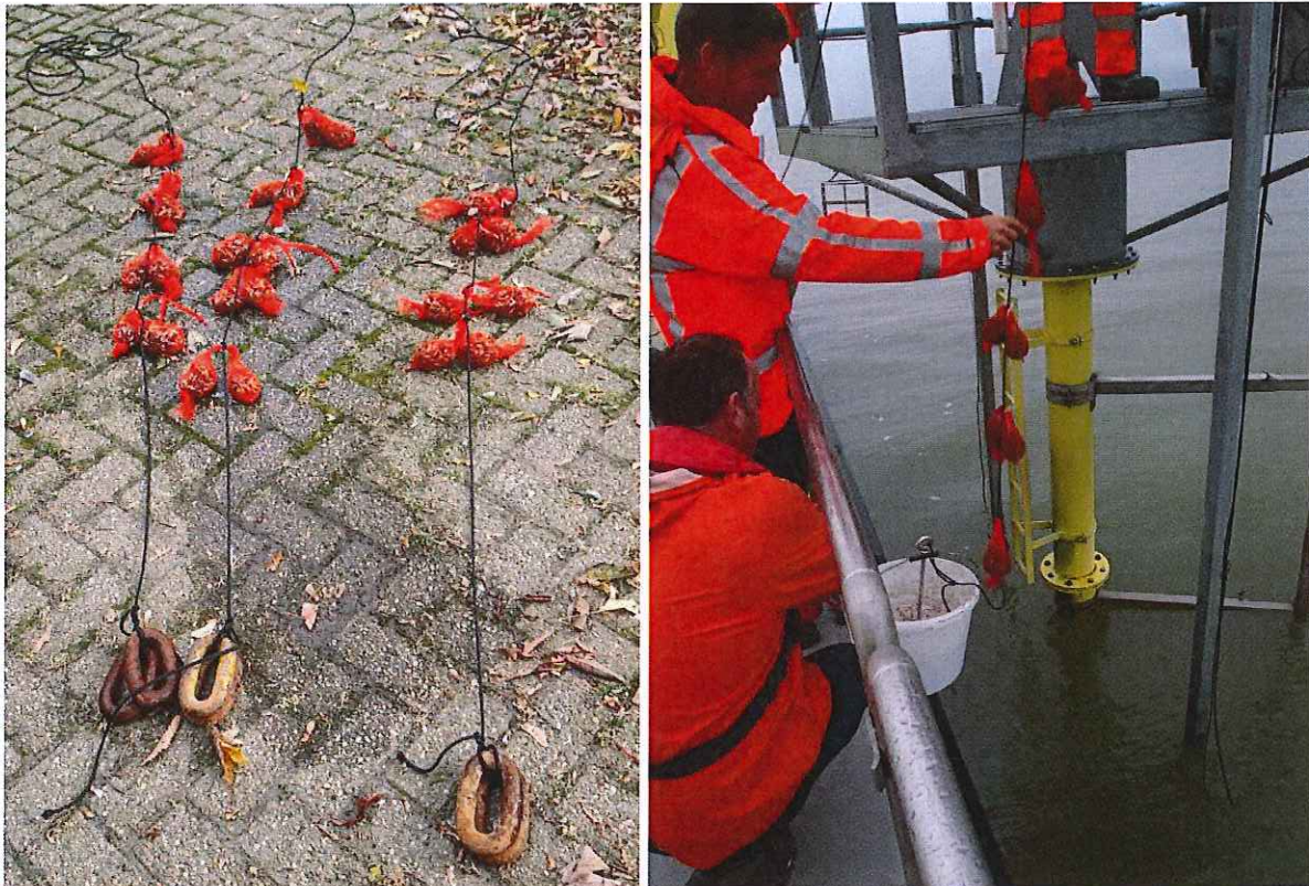
Figuur 2. Voorbeelden van het uithangen van de mosselen. Bevestiging van de mosselen aan het koord (links) met schakels als gewichten, uithangen van een koord aan een meetpaal met een cementanker om het koord strak te houden (rechts).
