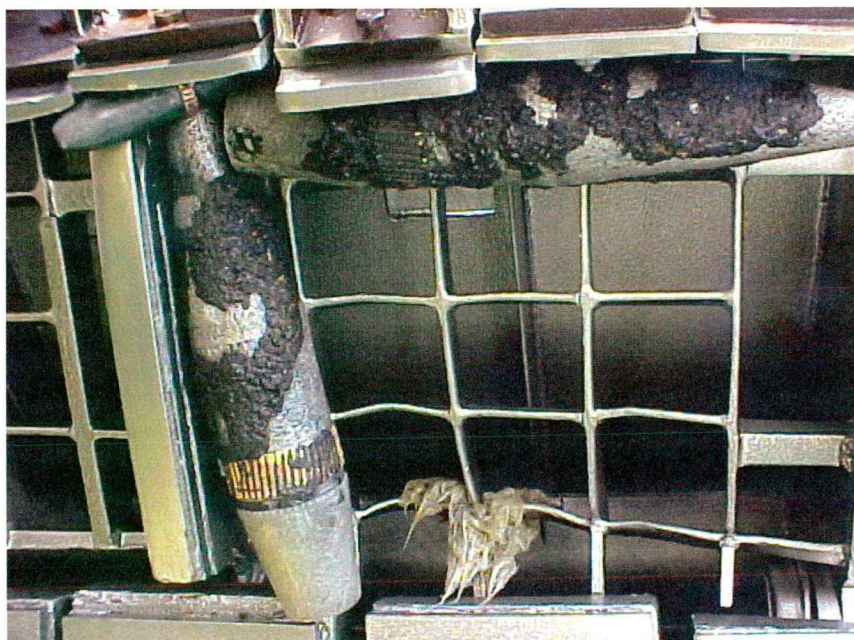
Figuur 5.1 Explosieven in zuigkop (vooroeversuppletie Callantsoog)
