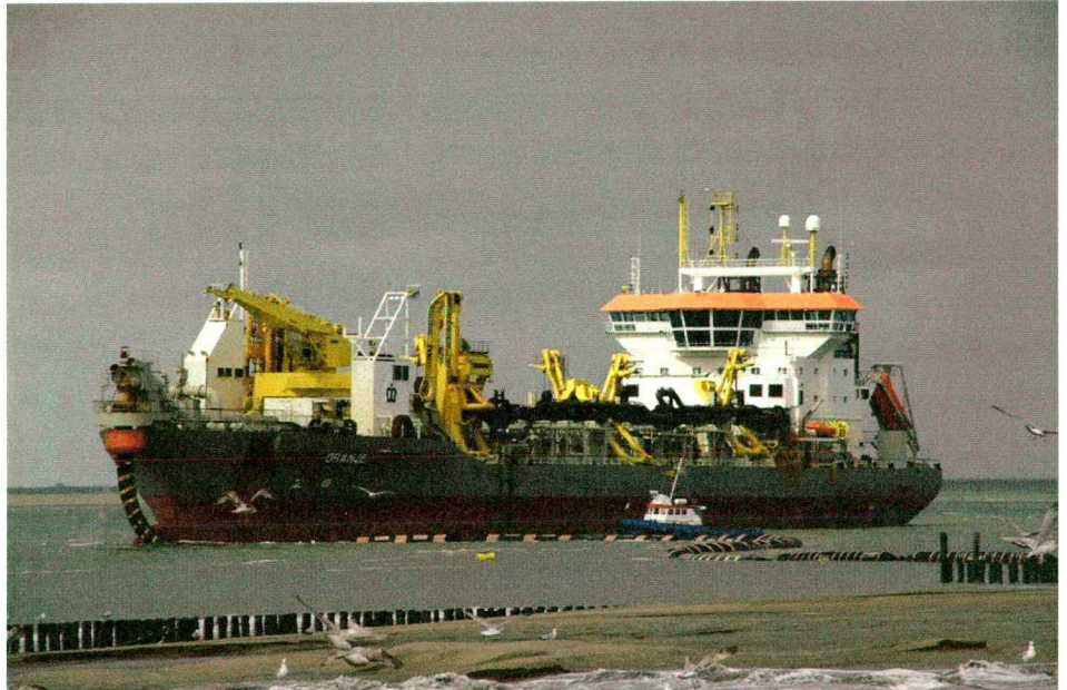
Figuur 5.2 Sleephopper 'Oranje' perst op het strand (strandsuppletie Walcheren)
