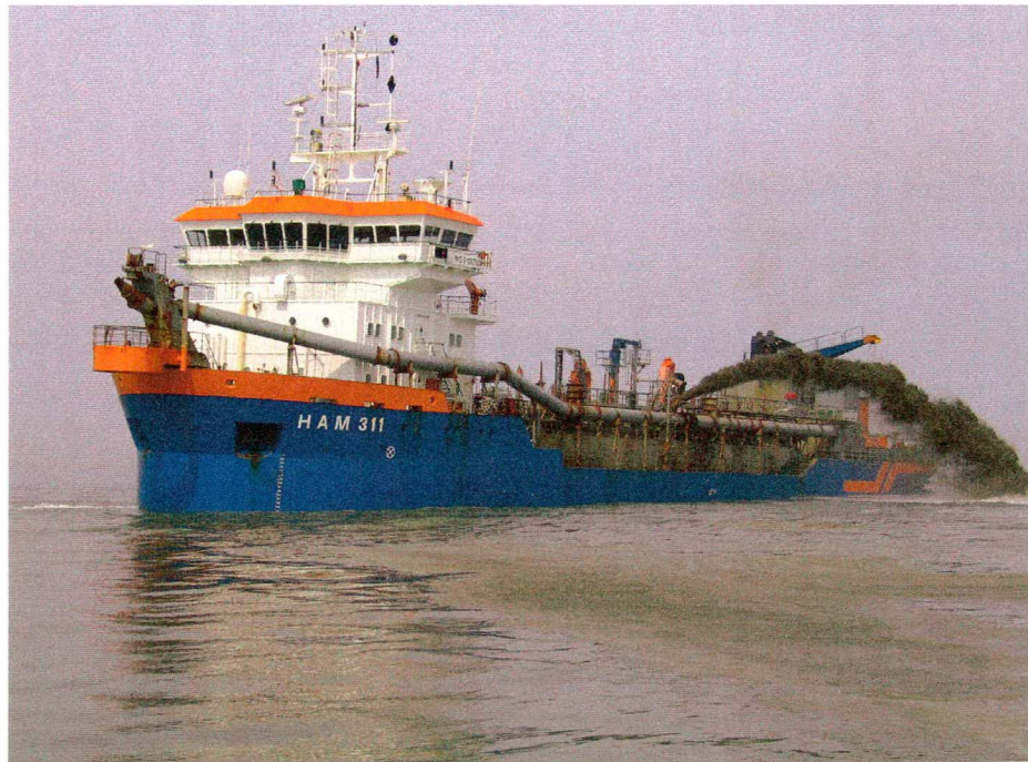
Figuur 7.1 Sleehopper 'HAM 311' tijdens rainbowen (vooroeversuppletie Noordwijk-Katwijk)
