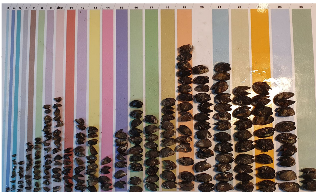
Figuur 5 Het indelen van mosselen per soort in lengteklassen van 1 mm (op foto: D. bugensis ).
