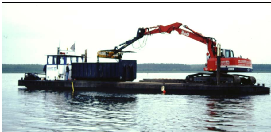
Foto 2. Hydraulische kraan met maaikorf op een zelfvarende bak (Matthijs Rutten)
