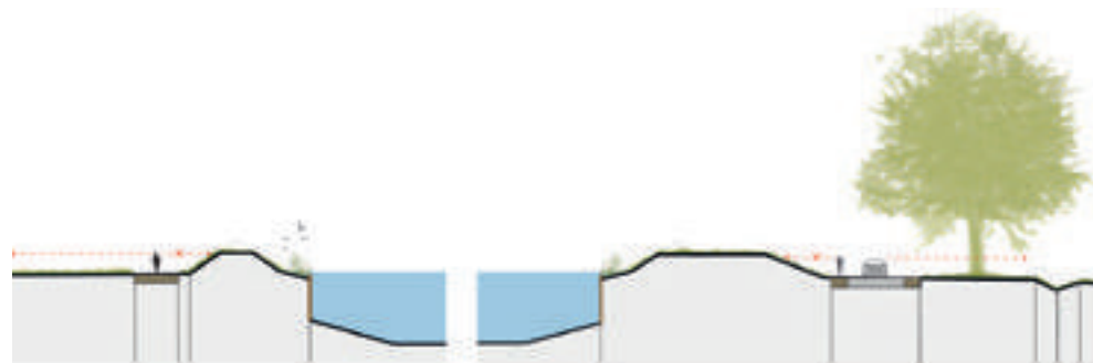
Principeprofiel Eemskanaal met begeleidende wegen/paden aan weerszijden
