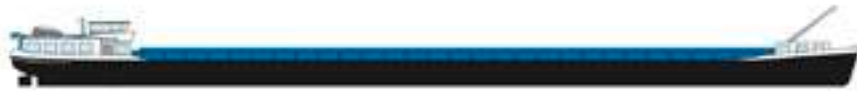
Maatgevend Groot Rijnschip met een lengte van 110 meter, een breedte van 11,4 meter en een maximale diepgang van 3,5 meter
