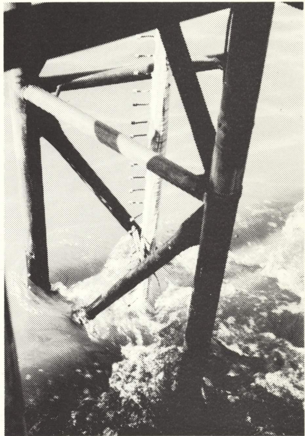
Steeltjes-stappenbaak voor meting van golven en getij (ontwikkeld eind jaren 50)
